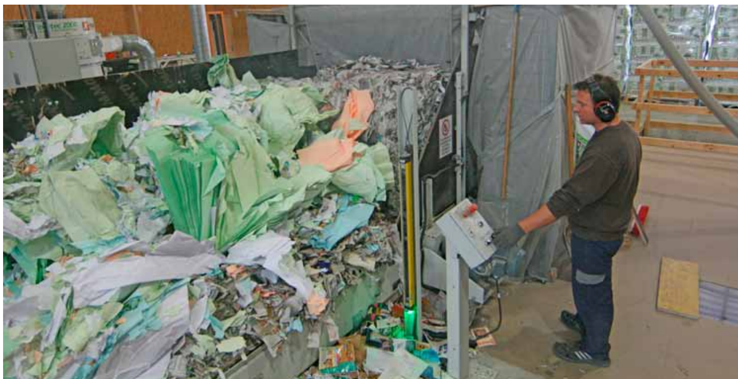
Chez Ouateco, des tonnes de papiers sont broyées puis mélangées avec du sel de bore pour obtenir la ouate de cellulose
